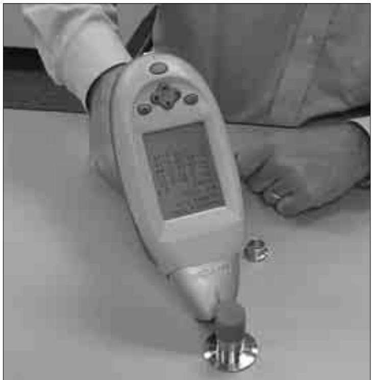
Prueba de identificación de aleaciones
